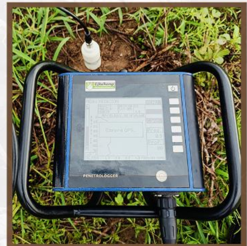
Figura 3. Evaluación de la resistencia a la penetración (MPa) con penetrologger.
